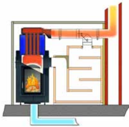
Provoz výměníku s klapkou Moritz
