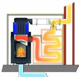
Provoz výměníku s klapkou Moritz
