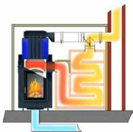
Provoz výměníku s klapkou Moritz
