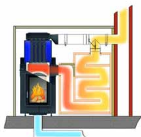
Provoz výměníku s klapkou Moritz
