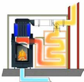
Provoz výměníku s klapkou Moritz
