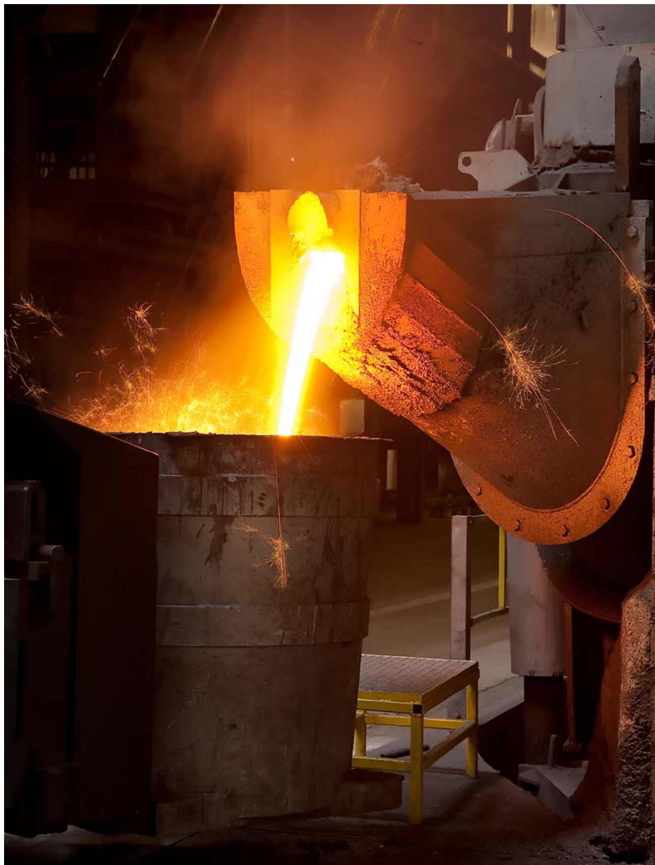
Přesun žhavé litiny o teplotě 1300°C z tavicí pece do výrobní linky. Belgie Weelde
