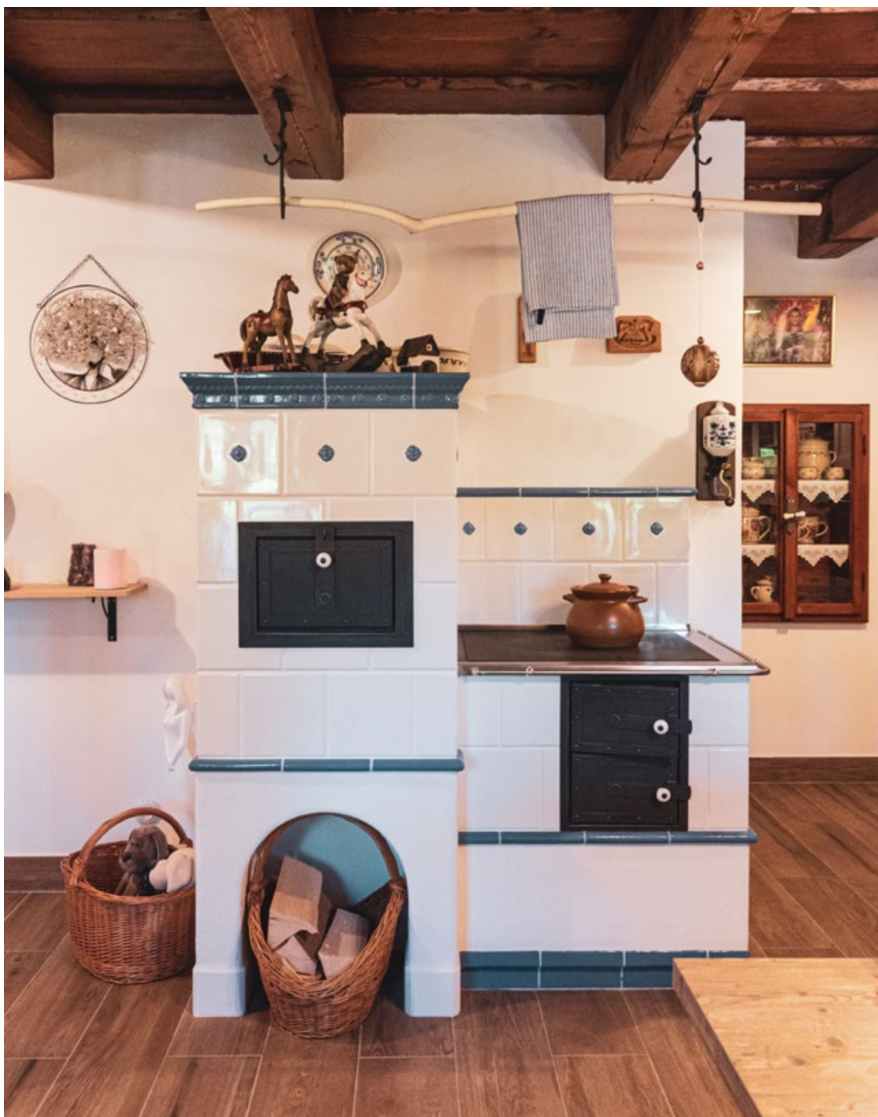
K práci glazovače patří i drobné dekorování. Dvoubarevný dekorovaný kachel musí glazovači nejprve naglazovat bíle a setřít dekor. Po vypálení kachel naglazují modrou glazurou reliéf a kachel putuje potřetí do pece. Nestárnoucí bílo-modrá klasická barevná kombinace kachlového sporáku z pod rukou kamnáře Dmytra Mishka. Kachle Kamnářství Bechyně, římsa Flóra a hladký kachel s ozdobnou kytkou Rustikal. Foto: Elena Butivšenko
