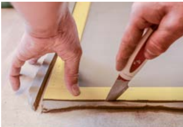
Příprava plátů, které následně slouží k výrobě jak základních kachlů, tak rohů.
