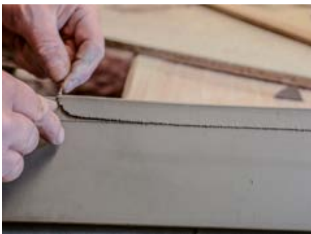
Výřez ozdobné drážky rohového kachle za pomoci struny. Zde velmi záleží na zručnosti mistra a na jeho fantazii.
