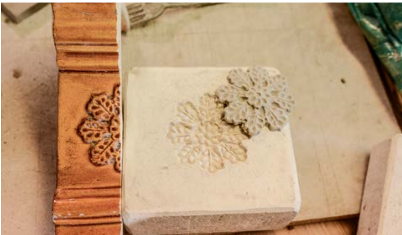
Sádrová forma k vytvoření dekoru dle původní předlohy. Dekor je dolepen na kachel v koženém stavu před prvním výpalem (přežahem).
