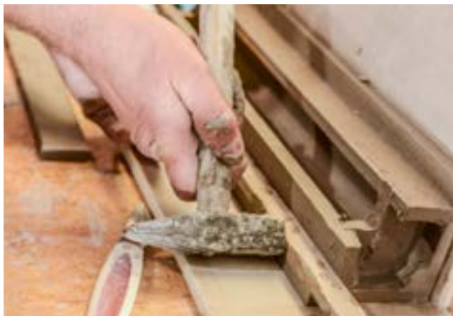
Výroba rohu s dolepenými žebry. Zde je krásně viditelné bednění, odtud název bedněné kachle.
